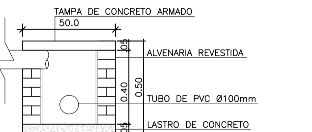
DETALHE 5 - CAIXA DE LIGAÇÃO ESCALA 1:20
