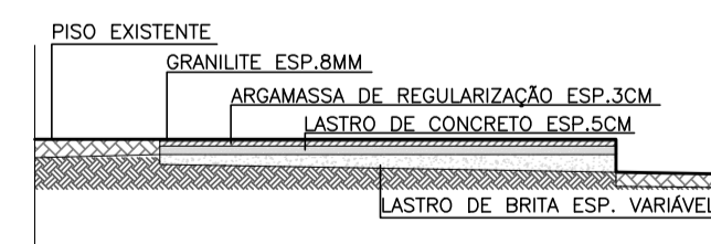
DETALHE 01 EXECUÇÃO DO PISO ESC.: 1:50
